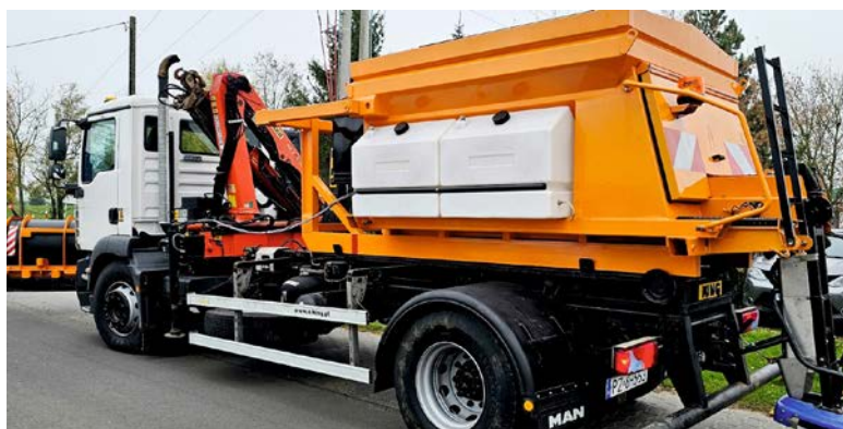
Podwozie hakowe DMC 18 ton z piaskarką 5
